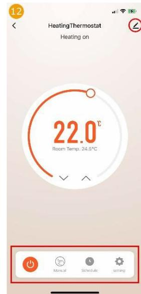
Das Bild zeigt die Hauptansicht des Thermostaten. Mittig wird groß die Soll-Temperatur (Setpoint) und darunter die aktuelle Raum-Temperatur angezeigt. Mittels der Pfeil-Tasten kann die Soll-Temperatur manuell angepasst werden. Die Funktionen der Button „Schalter“, „Modus“, „Schedule“, „Setting“ werden in den Bildern 13, 14, 17 und 15 erläutert.
