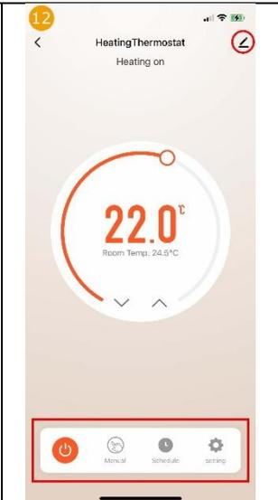
Das Bild zeigt die Hauptansicht des Thermostaten. Mittig wird groß die Soll-Temperatur (Setpoint) und darunter die aktuelle Raum-Temperatur angezeigt. Mittels der Pfeil-Tasten kann die Soll-Temperatur manuell angepasst werden. Die Funktionen der Button „Schalter“, „Modus“, „Schedule“, „Setting“ werden in den Bildern 13, 14, 17 und 15 erläutert.
