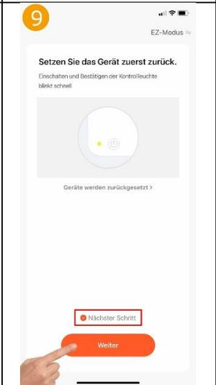
Thermostat in den Anlernmodus setzen: Am Thermostat die Ein/Aus-Taste ca. 3 Sekunden drücken, bis das WLAN-Symbol im Display erscheint. Nun kurz die „+“ Taste drücken, das WLAN-Symbol blinkt und das Thermostat befindet sich im Anlernmodus. Nun in der App zunächst auf „Nächster Schritt“ und dann auf „Weiter“ tippen.
