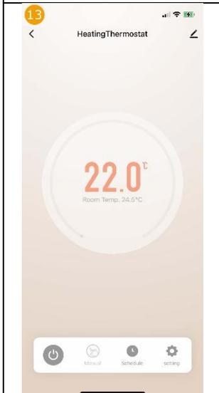
Durch antippen von „Schalter“ kann das Thermostat aus- bzw. eingeschaltet werden.
