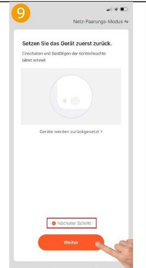
Anlernmodus: Auf das WLAN-Symbol oben am Display-Rand und dann unten auf das WLAN-Hand-Symbol tippen. Es erscheint „Waiting for connection“ im Display. Nun in der App zunächst auf „Nächster Schritt“ und dann auf „Weiter“ tippen.
