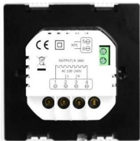
**2 & 3** Eingangsklemme für die 230V/AC Versorgungsspannung des Thermostaten
