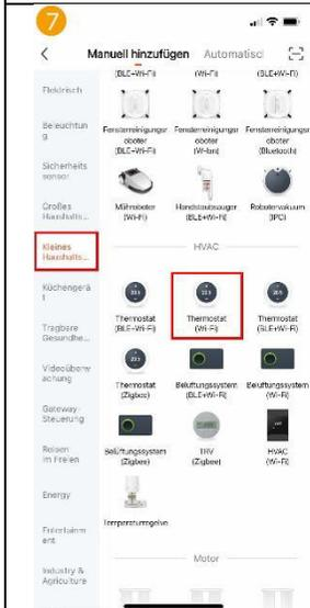
Zur Einbindung eines Thermostaten ist links auf „Kleines Haushaltgerät“ zu tippen und anschließend rechts „Thermostat Wi-Fi“ auszuwählen. **Nicht Bluetooth, Zigbee, BLE+Wi-Fi wählen!**
