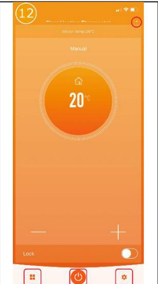
Mittig wird groß die Soll-Temperatur und darüber die aktuelle Raum-Temperatur (Indoor Temp) angezeigt. Mittels Plus/Minus-Taste kann die Soll-Temperatur angepasst werden. Mittels „Lock“ kann die Tastensperre ein/ausgeschaltet werden. Funktionen der weiteren Buttons siehe 13, 14, 15, 18.
