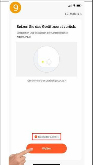
Thermostat in den Anlernmodus versetzen: Thermostat abschalten und die Eco-Taste (Taste 3) für ca. 5 Sekunden drücken, bis das WLAN-Symbol im Display erscheint. Nun in der App zunächst auf „Nächster Schritt“ und dann auf „Weiter“ tippen.
