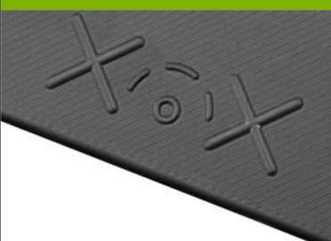
Genau an diesen Markierungen kann die PRO-MAT Modul durchbohrt werden. Es darf max. eine Bohrung im durchgängigen Mittelkreis der Markierung gesetzt werden oder mit max. 5mm Schrauben durch geschraubt werden. Der gestrichelte Kreis, dient nur zur Orientierung und besseren Sichtbarkeit.
