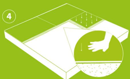
Die Ultralight muss auf ein frisch mit einem Zahnpachtel aufgetragenes Klebebett gebettet werden und gründlich in das Bett eingedrückt werden, um sicherzustellen, dass unter den Platten keine Hohlräume verbleiben. Alle Platten müssen im Versatz verlegt werden.
