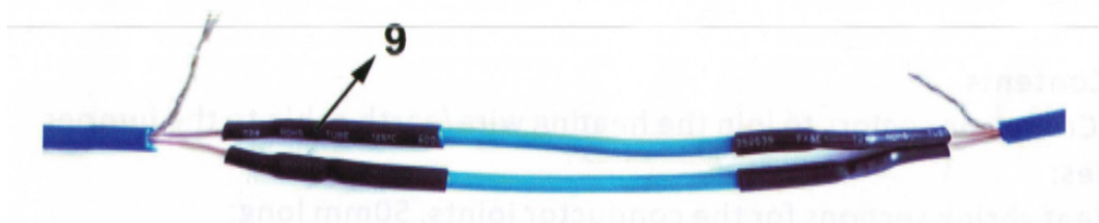
Schritt 9 - Schrumpfschläuche über den einzelnen Leiterverbindungen. Darstellung schematisch.
