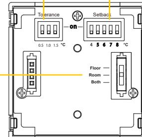
Entfernen Sie die Frontschale. Die drei DIP-Schalter sind jeweils mit Temperaturtoleranz, Absenkung und Sensoroptionen gekennzeichnet. In den folgenden Abbildungen wird beschrieben, wie die Parameter eingestellt werden.
