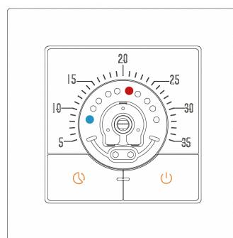
Beim Aufstecken des Einstell-Rades ist darauf zu achten, dass sich der Punkt auf dem Knopf zwischen dem roten und blauen Grenzstiften befindet. Auf diese Weise wird der Drehbereich beispielhaft auf den Bereich von 10-20° begrenzt.
