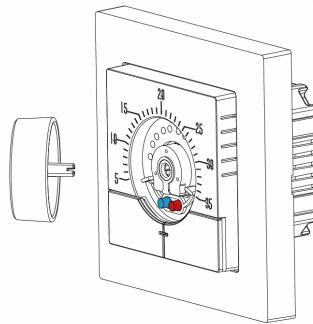
Stecken Sie den roten und blauen Stift in die Löcher (siehe Abbildung), um den gewünschte min. und max. Temperatur einzustellen. Das Bild zeigt z.B. die Begrenzung auf einen einstellbaren Temperaturbereich zwischen 10 und 20°C.
