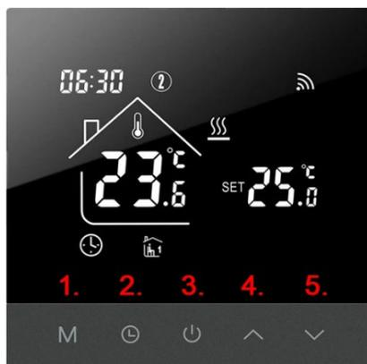
1. M-Taste, kurzer Tastendruck wechselt den Betriebsmodus, langer Tastendruck (3 Sek.) öffnet die Programmierung für das Wochenprogramm. Zum Einstellen ▲ / ▼ und zum Bestätigen die M-Taste drücken. Zum Speichern die Uhrzeit-Taste drücken.
