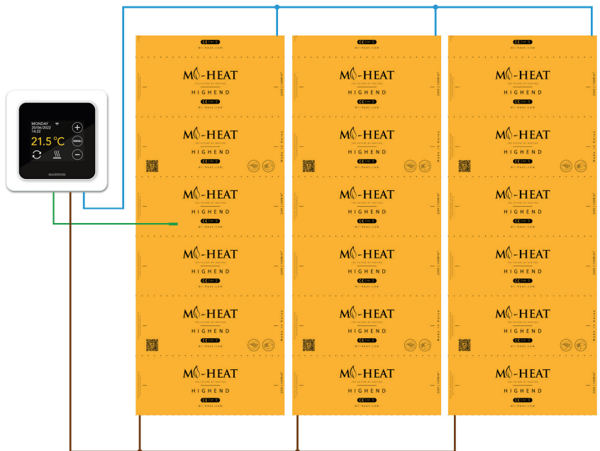
Getrennte Verlegung der Anschlussleitungen (L und N) / grün = externer Bodensensor
