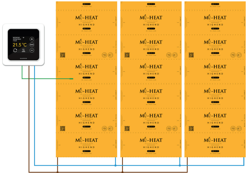
Einseitige Verlegung der Anschlussleitungen (L und N) / grün = externer Bodensensor
